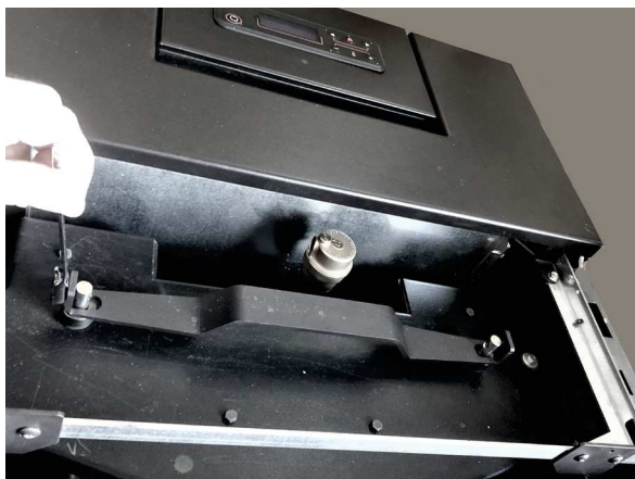
Fig. 93 - Svitare vite utilizzando chiave da 8
