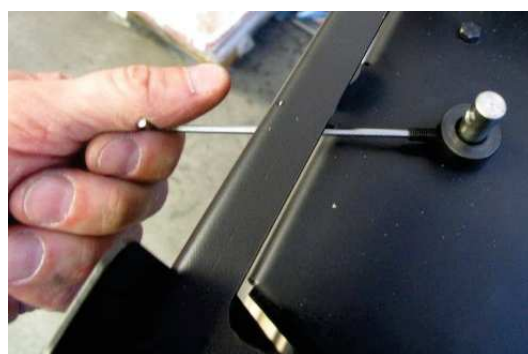
Fig. 96 - Svitare vite utilizzando chiave da 2,5
