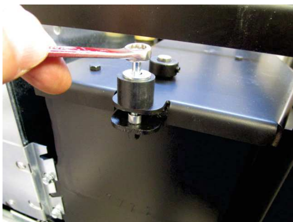
Fig. 95 - Svitare vite utilizzando chiave da 8
