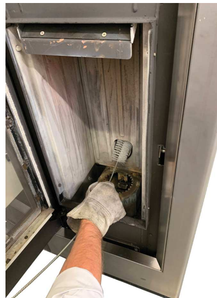
Fig. 32 - Reiniging met flessenwisser
