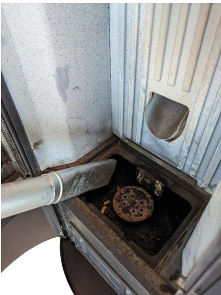
Fig. 31 - Reiniging ruimte vuurpot
