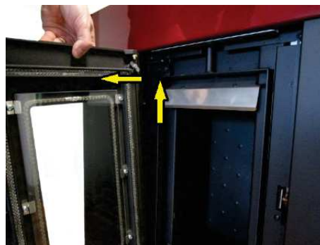
Fig. 18 - Desmontaje de la puerta
