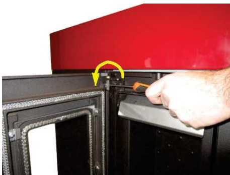
Fig. 17 - Extracción de los tornillos
