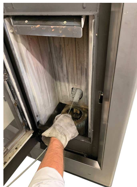
Fig. 32 - Limpieza con escobilla
