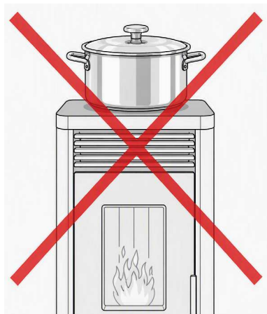
Fig. 24 - No cerrar las rejillas de salida del aire
