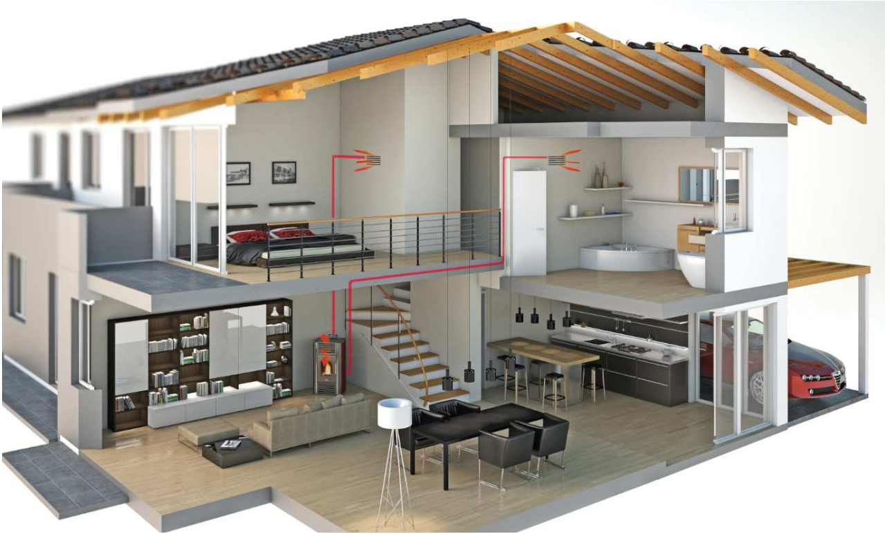
Fig. 48 - Beispiel einer Kanalisierung
