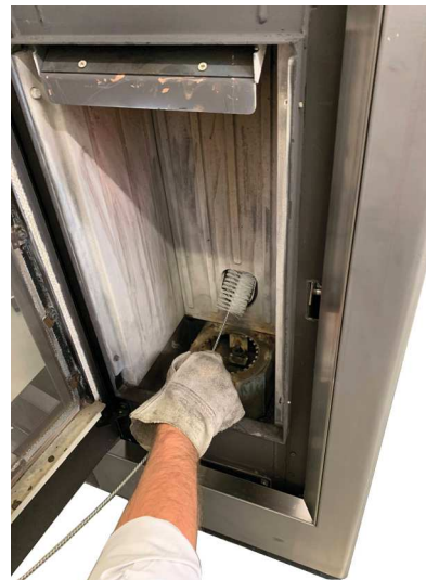
Fig. 32 - Reinigung mit Flaschenbürste
