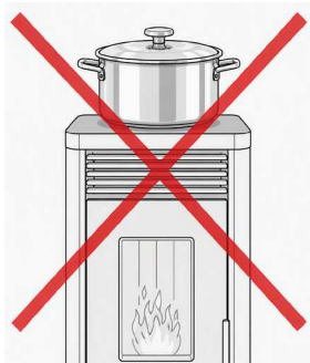
Fig. 24 - Die Lüftungsschlitze nicht verdecken
