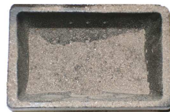
Fig. 28 - Beispiel für eine schmutzige Brennschale
