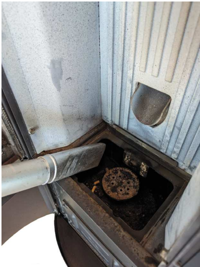
Fig. 31 - Reinigung Fach Brennschale
