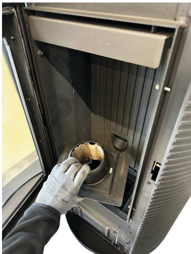
Fig. 54 - Remove the burning pot
