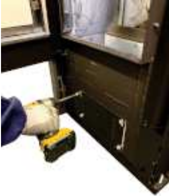
Fig. 68 - Remove the cap
