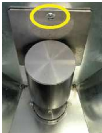
Fig. 92 - Retrait des vis
