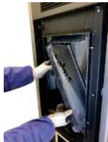
Fig. 79 - Retirer les parois latérales du foyer
