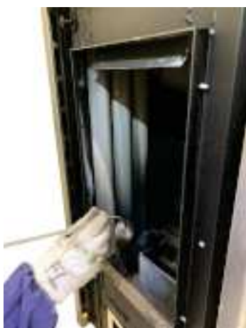
Fig. 80 - Nettoyer avec un goupillon
