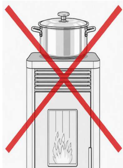
Fig. 24 - Ne pas obstruer les fentes d'air
