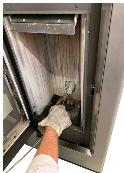
Fig. 32 - Nettoyage avec nettoie-pipes
