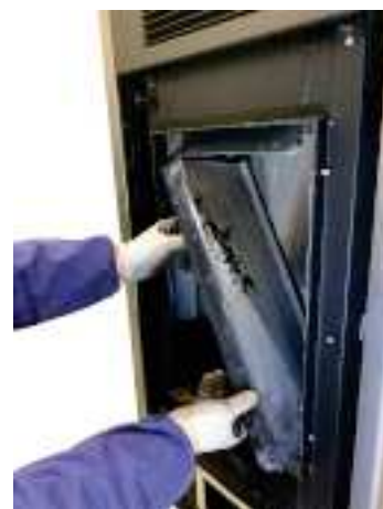
Fig. 65 - Rimuovere le pareti laterali
