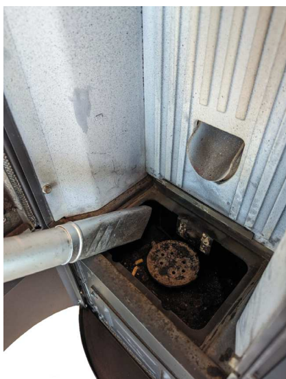
Fig. 74 - Pulizia vano braciere
