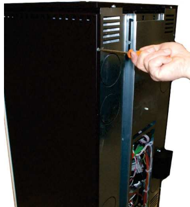
Fig. 28 - Lösen der hinteren Schraube
