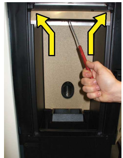
Fig. 36 - Beide Rohre reinigen
