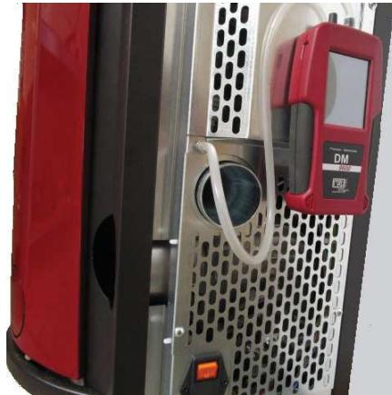
Fig. 17 - Anschluss des Digitaldruckwächters
