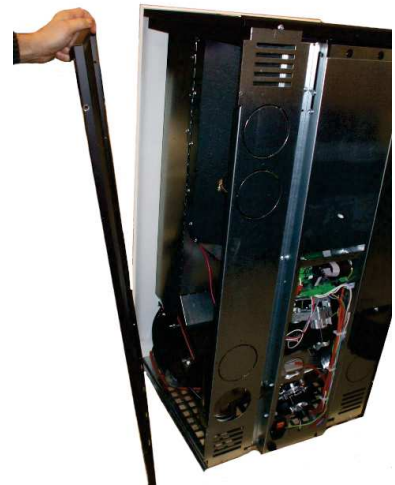
Fig. 29 - Abnehmen der Seitenwand
