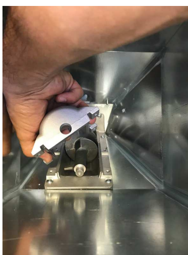
Fig. 29 - Retrait de la coque
