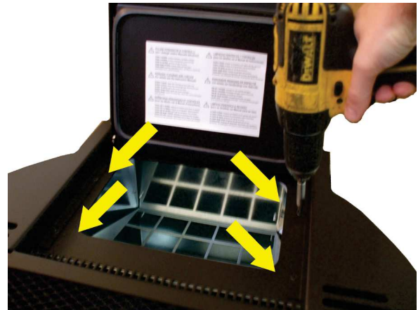
Fig. 40 - Enlèvement des vis du couvercle 2
