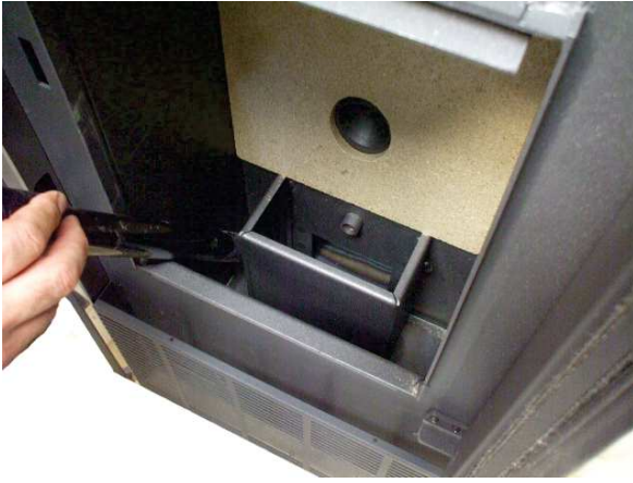
Fig. 36 - Nettoyage l'espace du brasero
