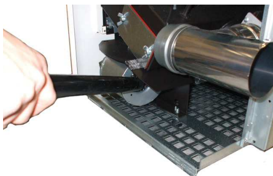
Fig. 42 - Pulizia ventilatore ambiente
