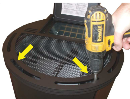
Fig. 30 - Rimozione viti coperchio 1
