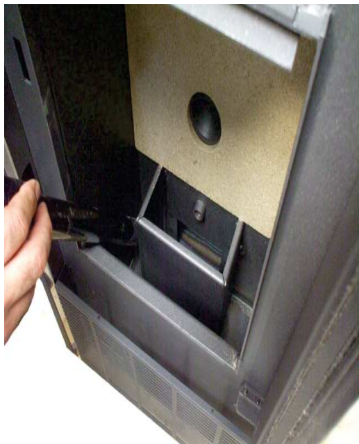
Fig. 36 - Pulizia vano braciere
