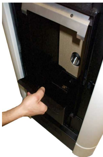
Fig. 34 - Rimozione cassetto cenere
