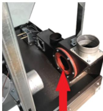
**Fig. 111 - Reinigung des Rauchgaskanals**
