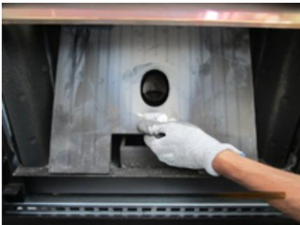
**Fig. 108 - Entfernung der mittleren Wand aus Gusseisen**
