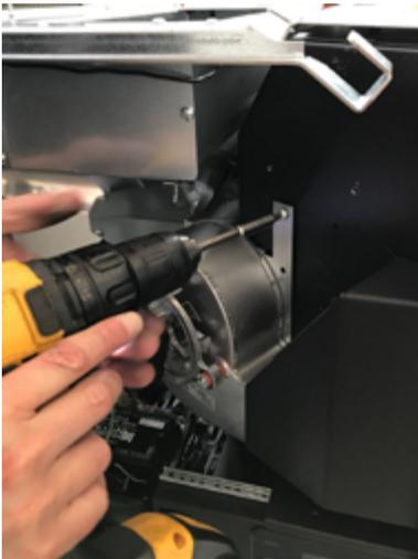
**Fig. 38 - Gebläse entfernen**
