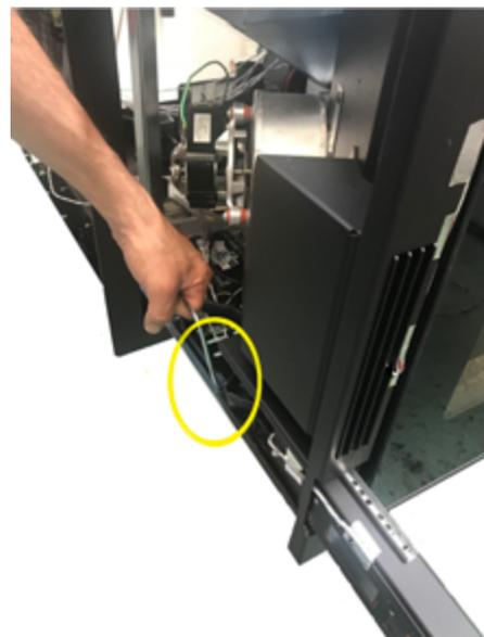
**Fig. 24 - Maschinenkörper entfernen**
