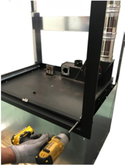
*Fig. 76 - Vordere Befestigung*
