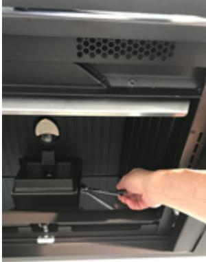
**Fig. 105 - Entfernung der kleinen Böden**
