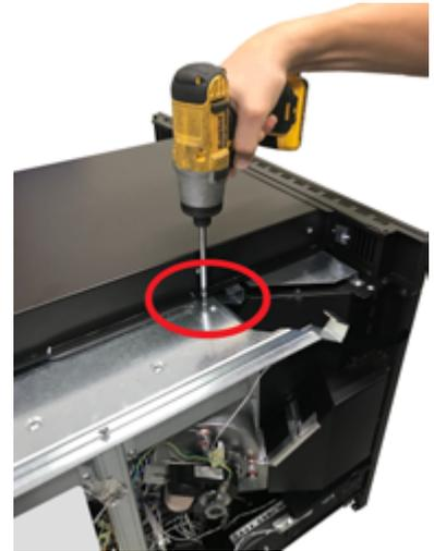
*Fig. 58 - Zentrale Befestigung Schublade*
