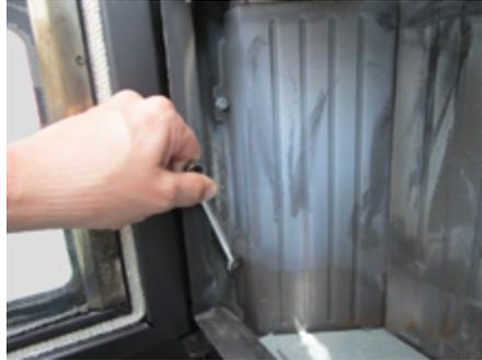
**Fig. 106 - Lösen der Schrauben**
