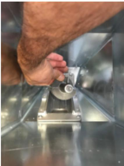
Fig. 90 - Spirale entfernen
