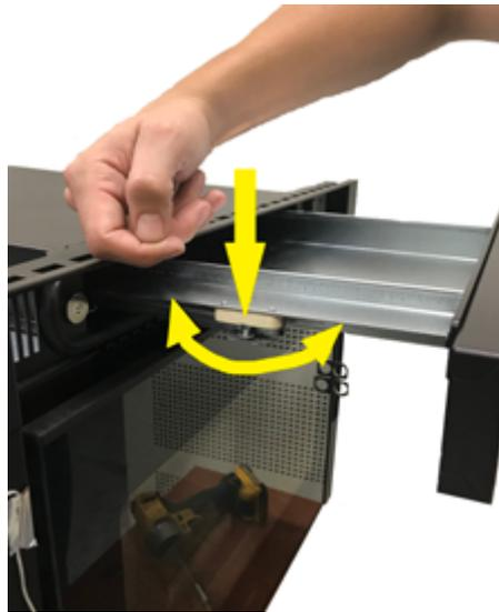
*Fig. 59 - Einstellung für die Zentrierung*
