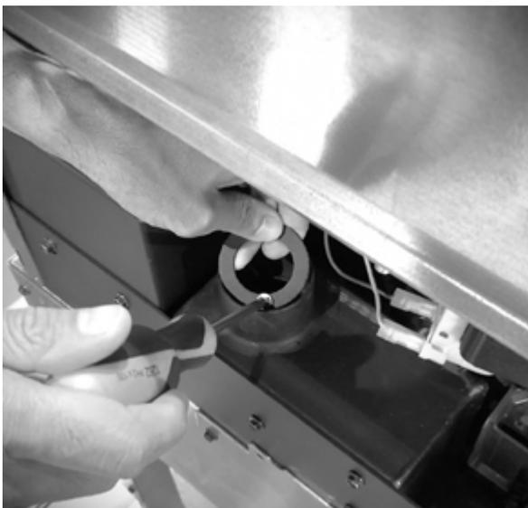
*Fig. 79 - Den Ring entfernen.*
