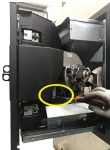
**Fig. 94 - Den Ventilator entfernen**
