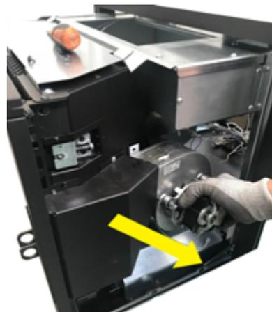
**Fig. 95 - Die Schrauben entfernen**
