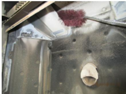
**Fig. 109 - Reinigung mit Flaschenbürste**
