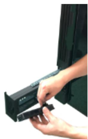
Fig. 86 - Das Display anschließen und neu positionieren
