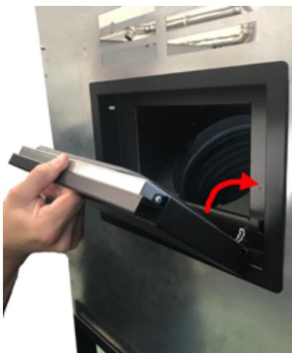
**Fig. 72 - Tür in die Ladeklappe fügen**
