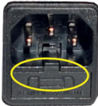
*Fig. 114 - Abdeckklappe mit Sicherungen, die ausgewechselt werden müssen*
