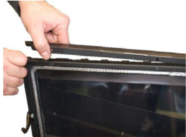
**Fig. 113 - Entfernen der Türprofile**
