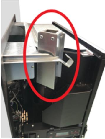
Fig. 44 - Luftabweichung positionieren
