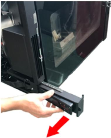
Fig. 81 - Das Display entfernen
