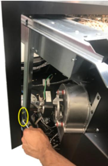
**Fig. 21 - Schrauben lösen**
