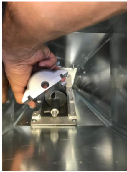
Fig. 88 - Gehäuse entfernen
