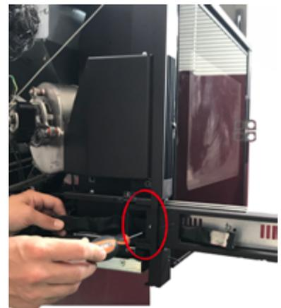
Fig. 83 - Die Schrauben entfernen
