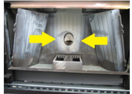
**Fig. 107 - Entfernung der Seitenwände aus Gusseisen**
