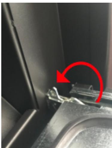
**Fig. 74 - Sicherheitshebel**
