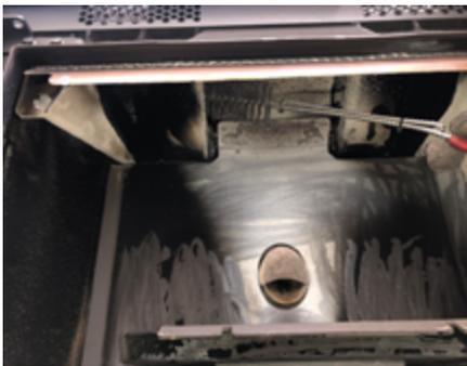
**Fig. 102 - Mit einer Rohrreinigungsbürste reinigen**
