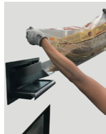
Fig. 36 - Pelletzufuhr über Rutsche
