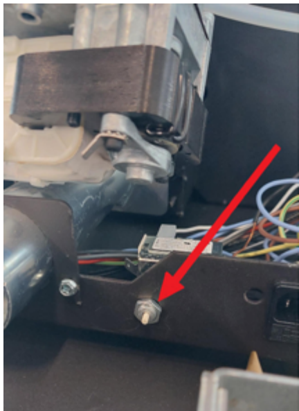
Fig. 40 - Manueller Reset: Befindet sich hinter dem Tank in der Nähe des Versorgungssteckers
