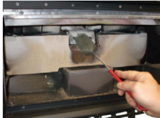
Fig. 47 - Reinigung mit Flaschenbürste
