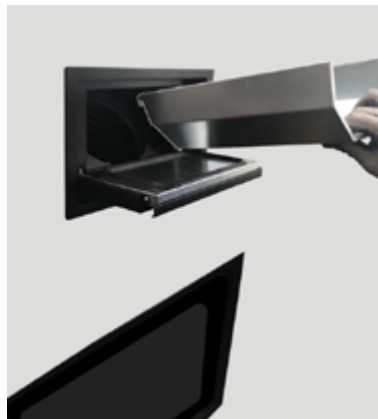
Fig. 35 - Befestigung der Rutsche
