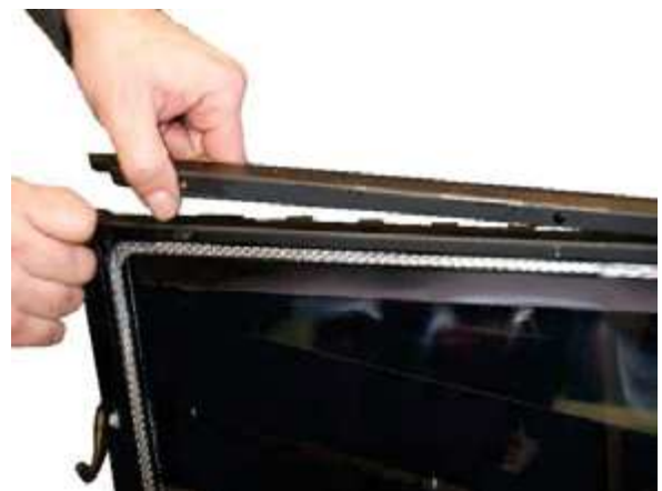
Fig. 113 - Door profiles removal
