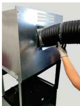
Fig. 67 - Plaatsing flexibele buis
