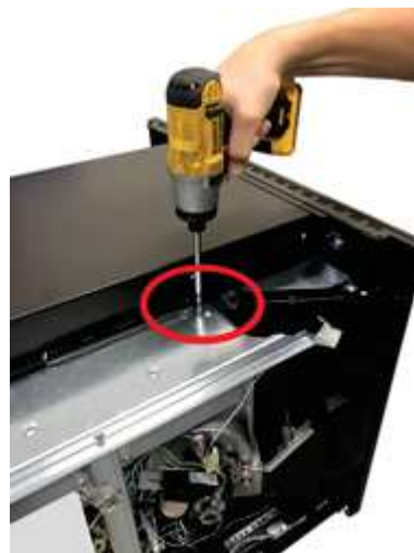
Fig. 58 - Centrale bevestiging lade
