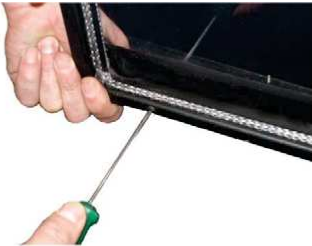
Fig. 112 - Verwijder de schroeven
