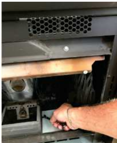
Fig. 98 - Verwijder de schroeven
