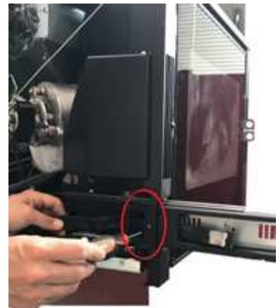
Fig. 83 - Verwijder de schroeven
