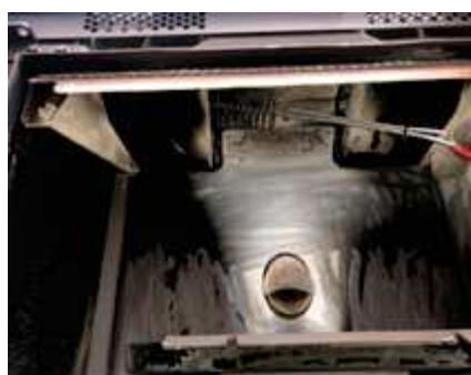
Fig. 102 - Reinig met pijpenwisser
