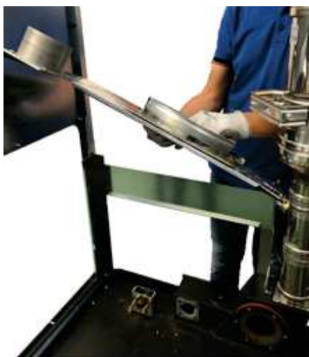
Fig. 60 - Verwijdering van de afdekking
