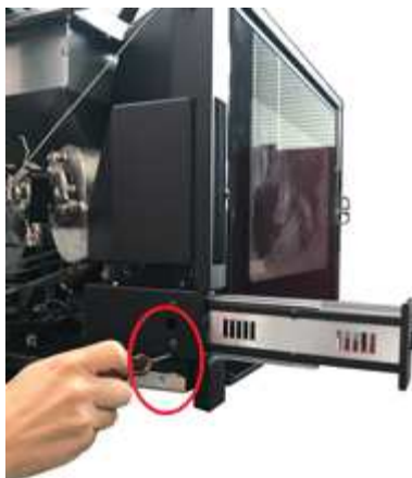
Fig. 85 - Zet de schroeven vast
