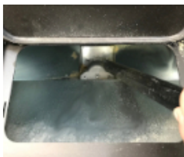
Fig. 48 - Reiniging van de voorraadbak
