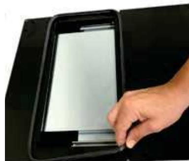
*Fig. 64 - Positionnement du joint d'étanchéité*
