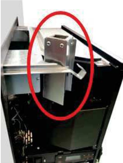
Fig. 53 - Positionner le déviateur de l'air
