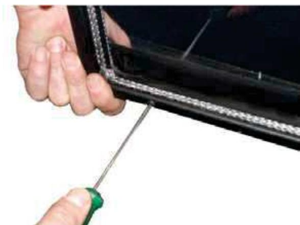
Fig. 121 - Extraction des vis
