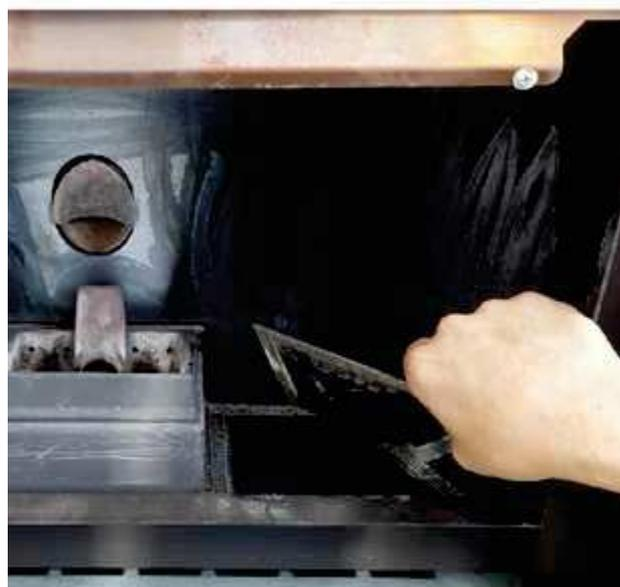
*Fig. 108 - Retirer le bouchon d'inspection*
