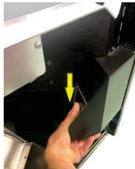
**Fig. 49 - Plier la languette**
