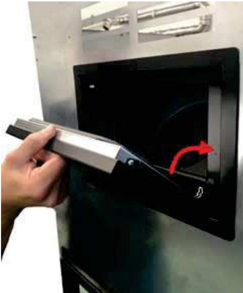
Fig. 81 - Insérer la porte dans la trappe
