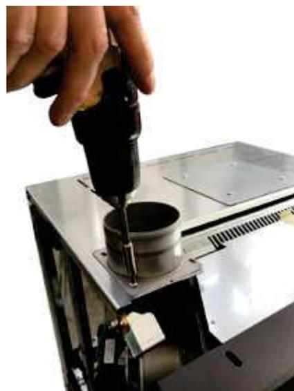
Fig. 57 - Fixer le raccord
