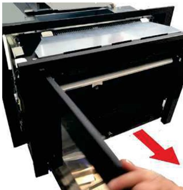
*Fig. 29 - Extraction du corps machine*
