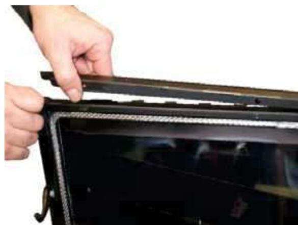
Fig. 122 - Extraction des profils de la porte
