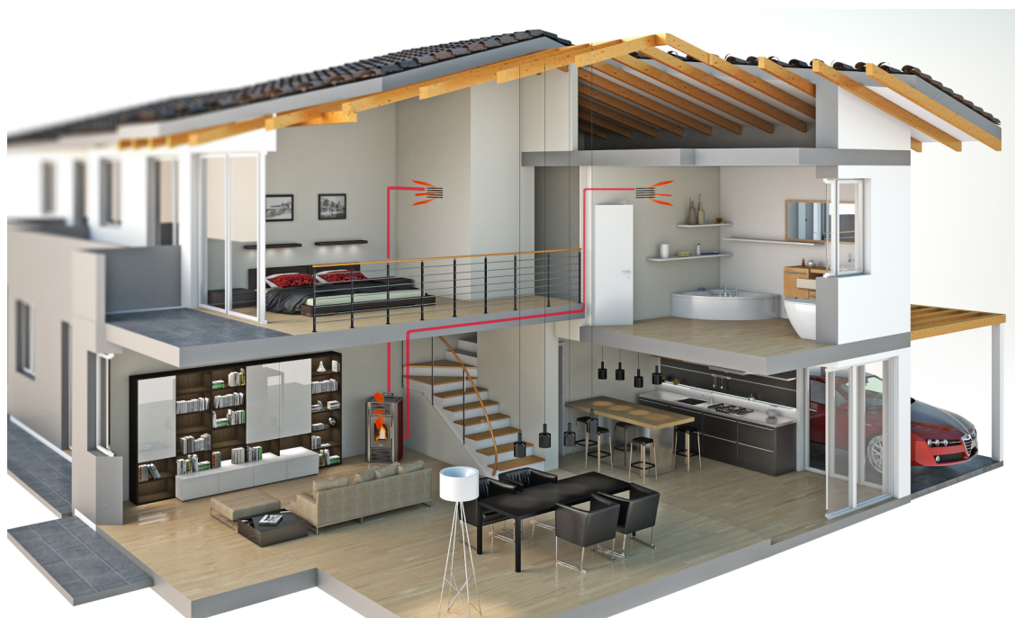
Fig. 50 - Esempio di canalizzazione
