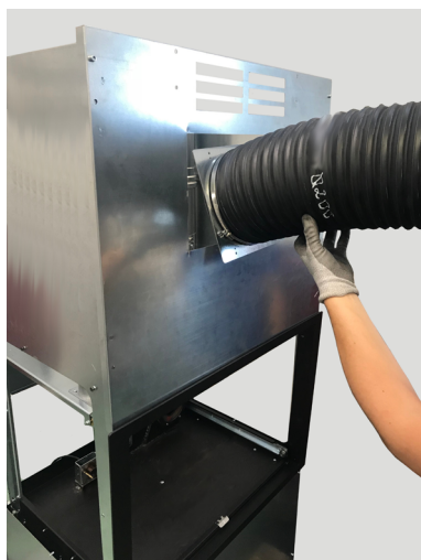
Fig. 67 - Posizionamento tubo flessibile
