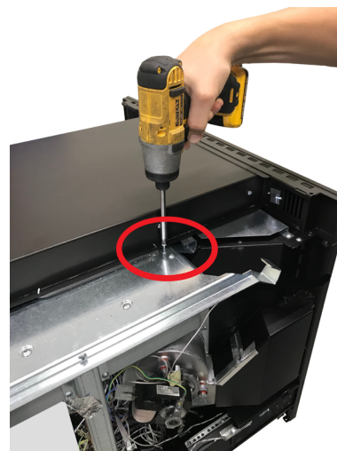
Fig. 58 - Fissaggio centrale cassetto
