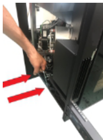
Fig. 24 - Rimozione corpo macchina
