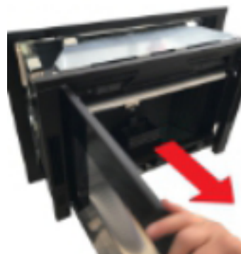
Fig. 25 - Estrazione corpo macchina
