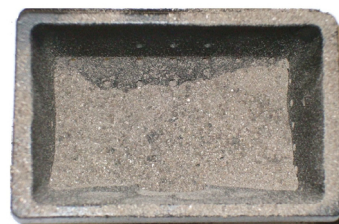
Fig. 42 - Esempio di braciere sporco
