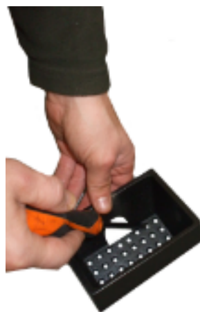
Fig. 31 - het schoonmaken van de vuurpot
