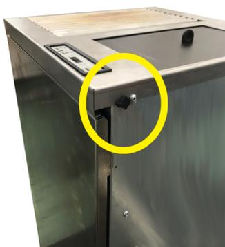
Fig. 25 - Extracción del tapón
