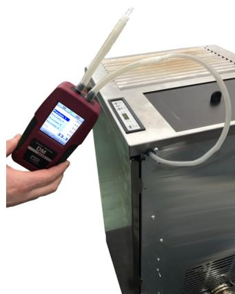
Fig. 26 - Conexión del presostato digital 1
