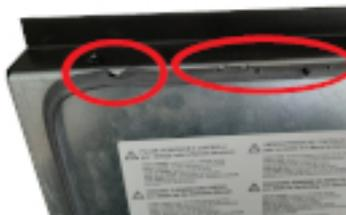
Fig. 24 - Junta deteriorada
