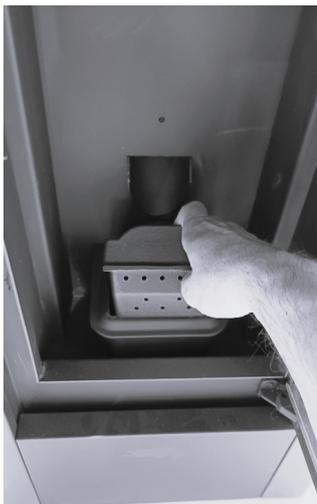
*Fig. 30 - Extracción del brasero*
