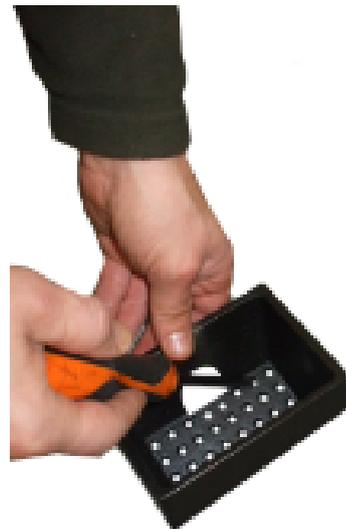
*Fig. 32 - Reinigung Brennschale*
