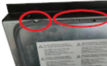
Fig. 25 - Verschlechterte Dichtung
