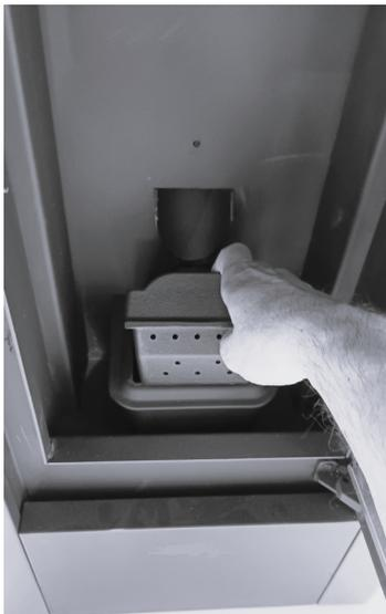
*Fig. 31 - Brennschale entnehmen*
