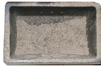
*Fig. 30 - Beispiel für eine schmutzige Brennschale*
