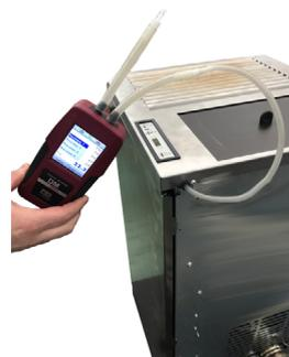
Fig. 33 - Connexion du pressostat numérique 1
