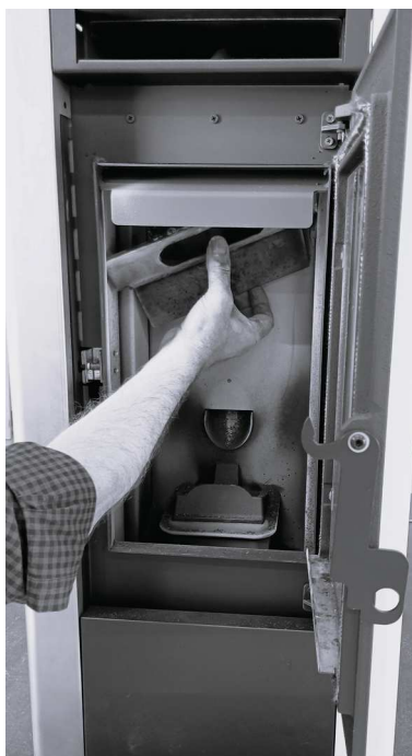
Fig. 27 - Rimuovere la testa del focolare 2
