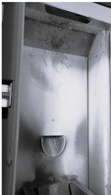
Fig. 26 - Rimuovere la testa del focolare 1
