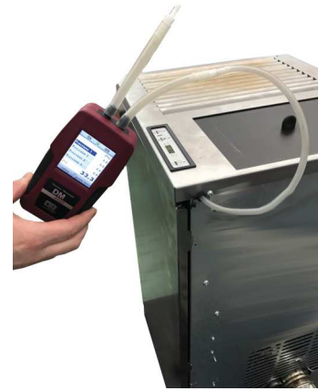
Fig. 24 - Collegamento pressostato digitale 1
