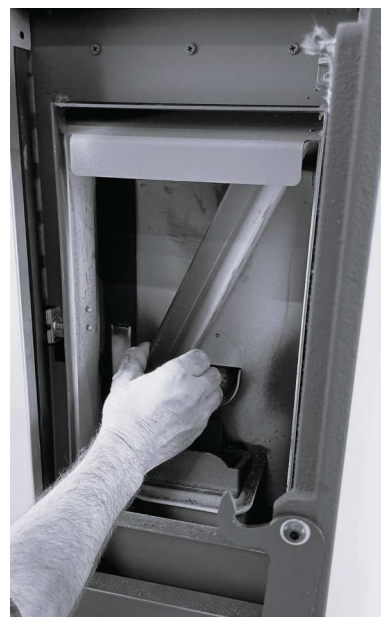
Fig. 28 - Rimuovere le pareti laterali del focolare
