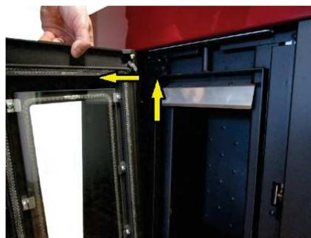
Fig. 7 - Desmontaje de la puerta
