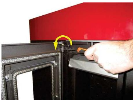
Fig. 6 - Extracción de los tornillos
