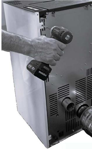
*Fig. 8 - Retire los tornillos*
