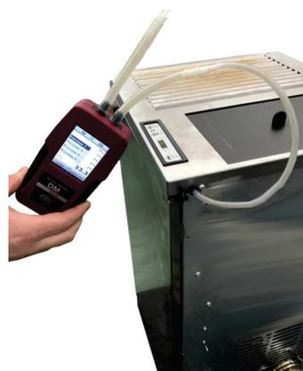
Fig. 15 - Conexión del presostato digital 1
