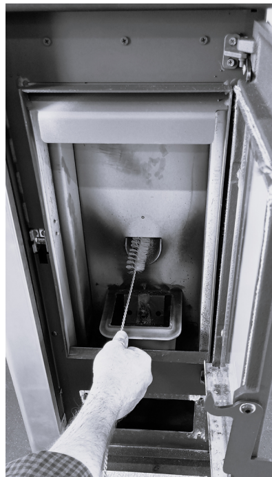
Fig. 42 - Limpieza con escobilla
