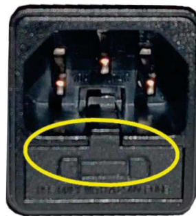
Fig. 30 - Abdeckklappe mit Sicherungen, die ausgewechselt werden müssen
