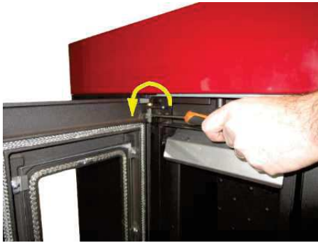
Fig. 11 - Entfernen der Schrauben
