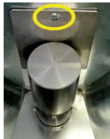
Fig. 32 - Entfernen der Schraube
