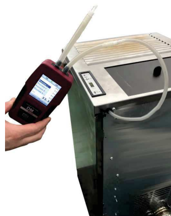
Fig. 20 - Anschluss des Digitaldruckwächters 1
