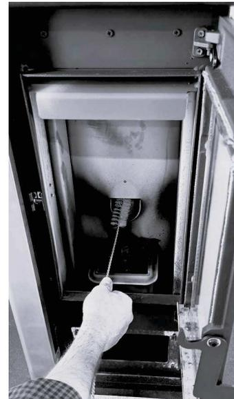
*Fig. 41 - Reinigung mit Flaschenbürste*
