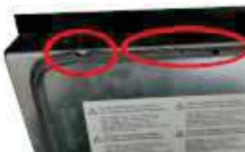
Fig. 24 - Verschlechterte Dichtung
