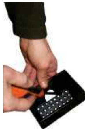
*Fig. 39 - Reinigung Brennschale*
