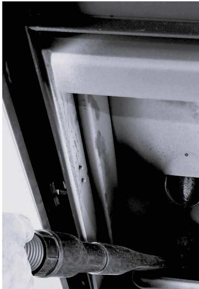
*Fig. 40 - Reinigung Fach Brennschale*
