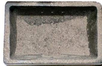
*Fig. 37 - Beispiel für eine schmutzige Brennschale*
