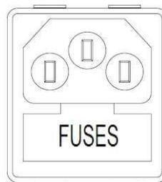
*Fig. 43 - Abdeckklappe mit Sicherungen, die ausgewechselt werden müssen*
