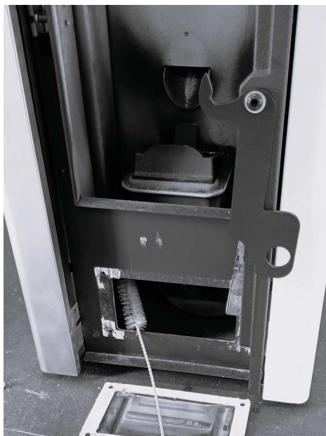
Fig. 37 - Nettoyer avec un goupillon.
