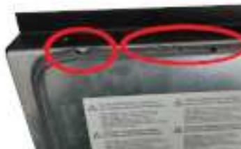
Fig. 23 - joint détérioré
