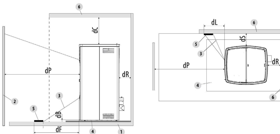
**Fig. 9 - Distanze di sicurezza da materiale combustibile**
