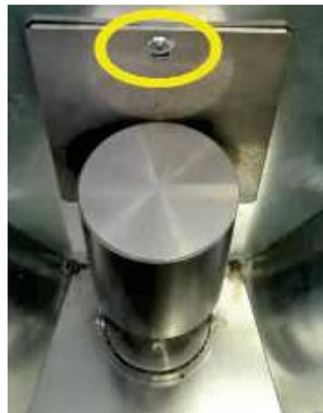
*Fig. 32 - Rimozione vite*
