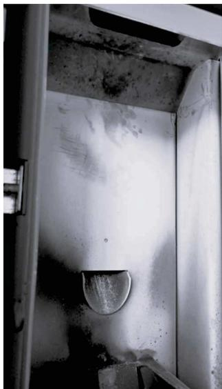
**Fig. 22 - Rimuovere la testa del focolare 1**
