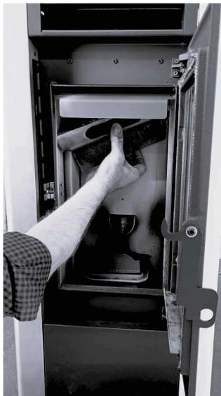
**Fig. 23 - Rimuovere la testa del focolare 2**
