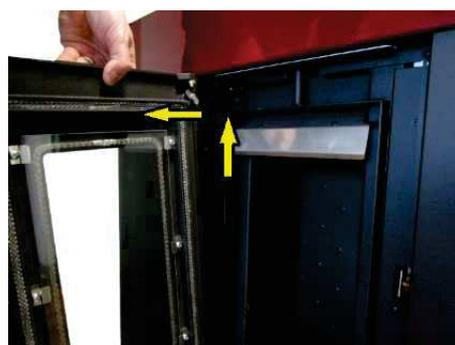
Fig. 12 - Rimozione porta
