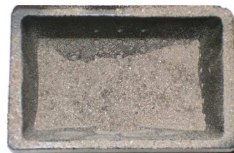
Fig. 36 - Esempio di braciere sporco
