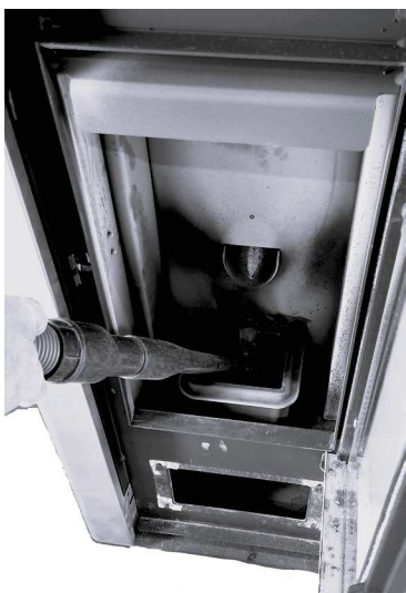
Fig. 39 - Pulizia vano braciere
