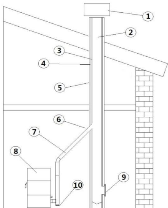
Fig. 2 - Bauteile Kamin
