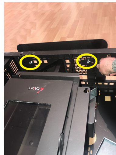
Fig. 73 - Blokkeer de schroeven
