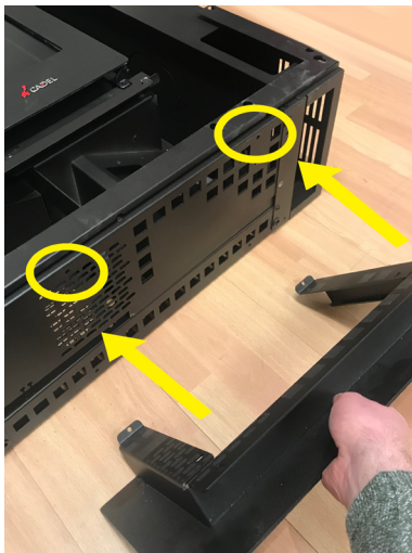
Fig. 71 - Plaats de sokkel
