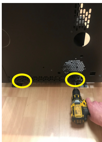
Fig. 74 - Bevestig de schroeven
