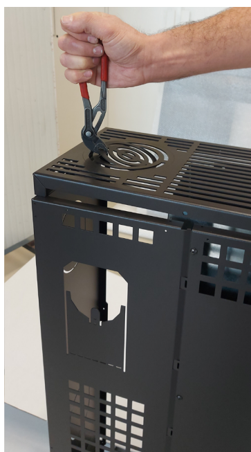
Fig. 69 - Verwijder het rooster
