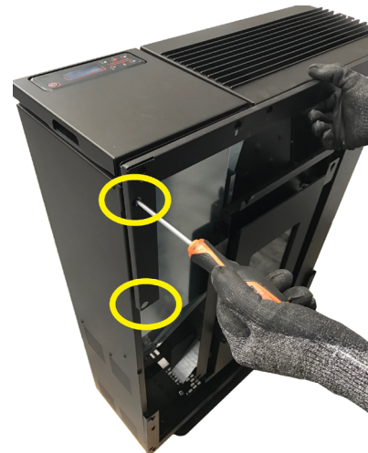
Fig. 42 - Bevestiging bovenste beugel
