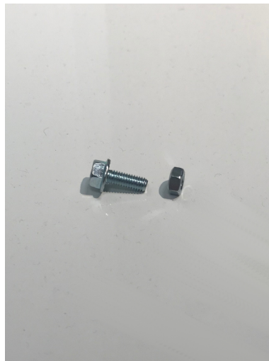
Fig. 72 - Zeskantschroef en bout
