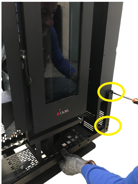
Fig. 34 - Bevestiging onderste beugel
