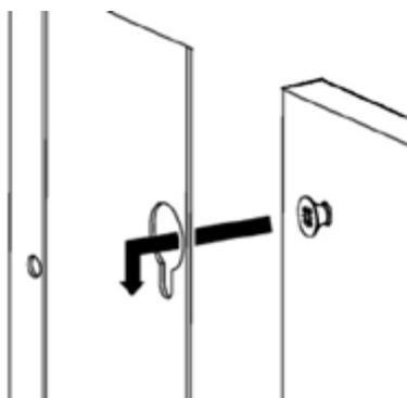
**Fig. 48 - Detalle de cómo se engancha**
