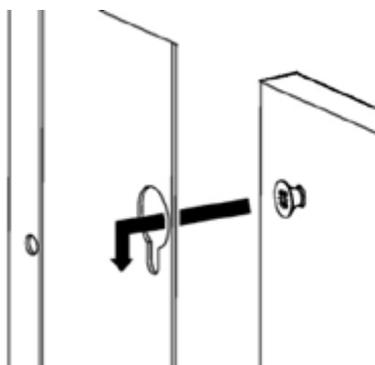
**Fig. 41 - Detalle de cómo se engancha**
