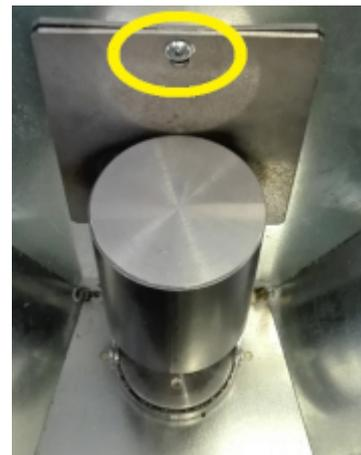
*Fig. 102 - Retirada del tornillo*
