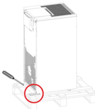
*Fig. 1 - Extracción de las abrazaderas*
