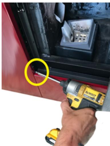
Fig. 52 - Extracción de los tornillos 1
