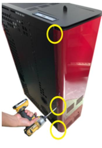
Fig. 56 - Extracción de los tornillos 4
