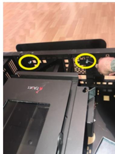
*Fig. 76 - Bloquee los tornillos*
