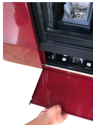
Fig. 54 - Desmontaje de las placas frontales delanteras
