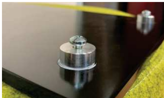
Fig. 46 - El tornillo debe sobresalir
