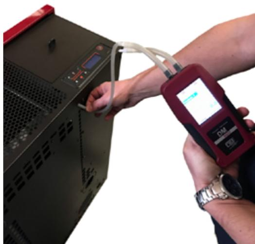
Fig. 87 - Conexión de presostato digital
