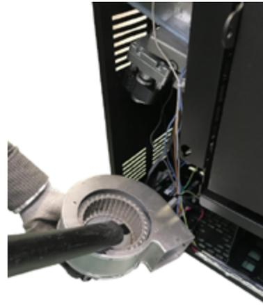
Fig. 96 - Limpieza del ventilador ambiente
