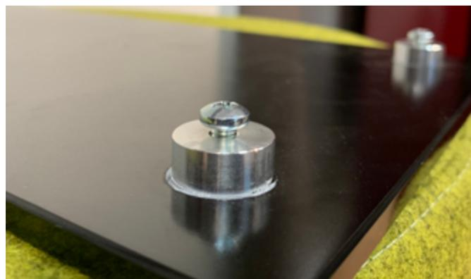
**Fig. 46 - El tornillo debe sobresalir**
