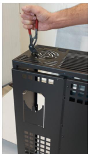
**Fig. 72 - Rompe los precortes**
