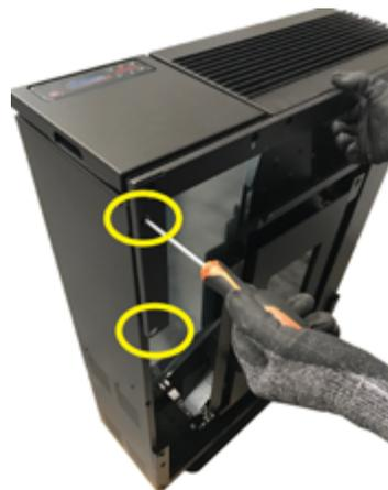
**Fig. 44 - Fijación de la abrazadera superior**
