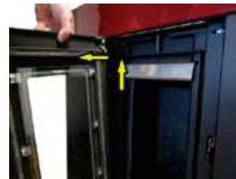
Fig. 29 - Desmontaje de la puerta
