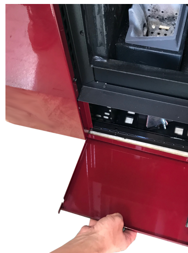
Fig. 52 - Ausbau der Einsätze
