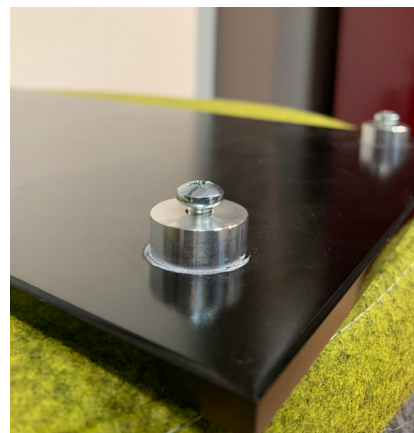
Fig. 44 - Die Schraube muss vorstehen
