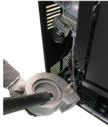
Fig. 95 - Reinigung des Raumventilators
