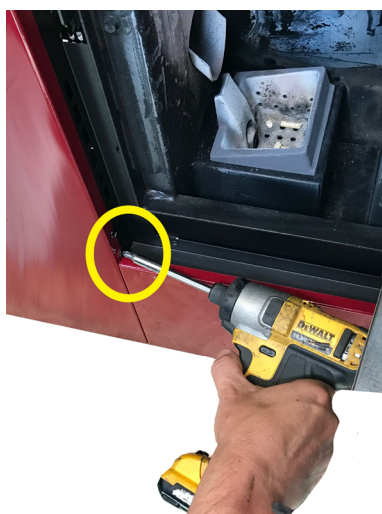
Fig. 59 - Retrait des vis 1
