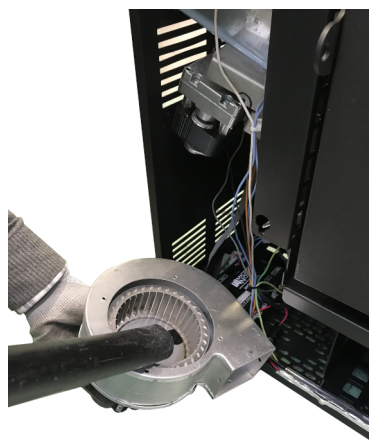
Fig. 104 - Nettoyage du ventilateur d'ambiance
