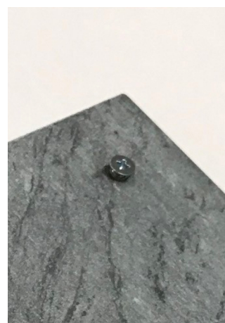
Fig. 46 - La vis doit dépasser
