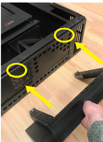
Fig. 82 - Mettre le piédestal en place
