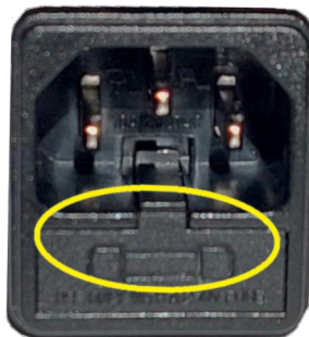
Fig. 105 - Hublot avec les fusibles à enlever
