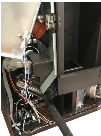
Fig. 102 - Nettoyage de le ventilateur ambiant
