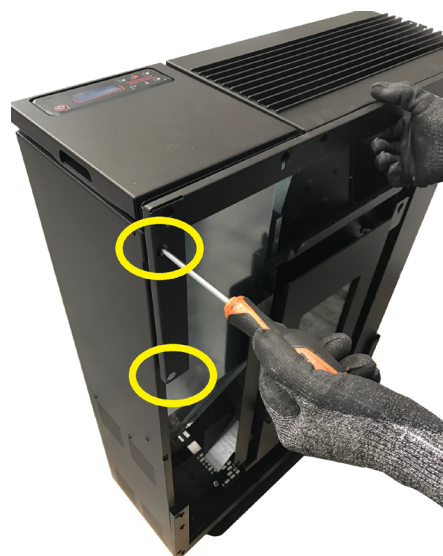
Fig. 44 - Fixation de l'étrier supérieur
