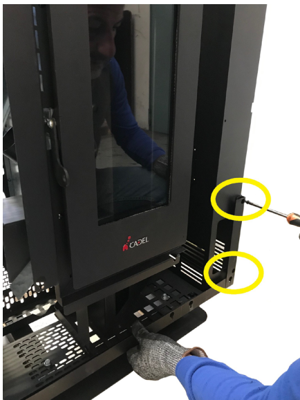
Fig. 50 - Fixation de l'étrier inférieur
