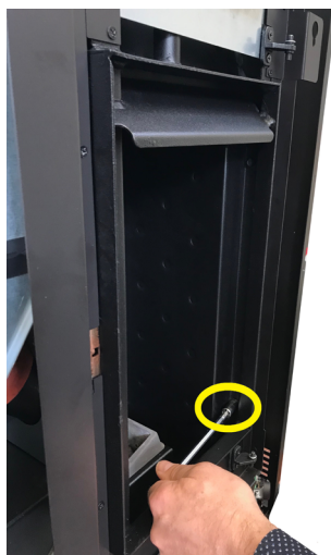
Fig. 99 - Retirer la vis 1
