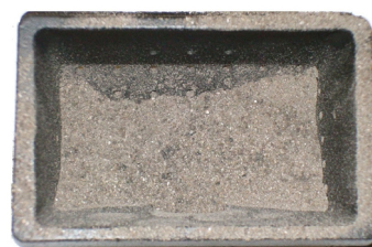
Fig. 33 - Esempio di braciere sporco
