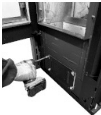
Fig. 64 - Retire la tapa
