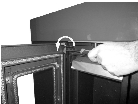
Fig. 15 - Extracción de los tornillos
