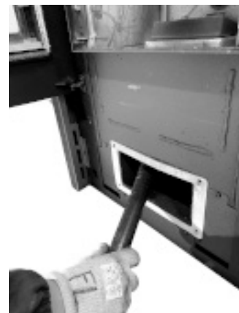
Fig. 54 - Aspire las cenizas
