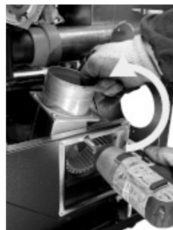
Fig. 37 - Gire el ventilador
