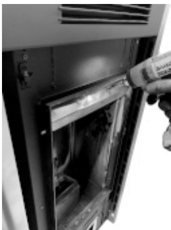
Fig. 56 - Retire el deflector
