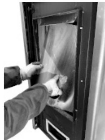
Fig. 61 - Extraiga la parte trasera del hogar
