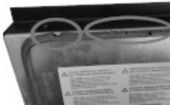
Fig. 27 - Junta deteriorada
