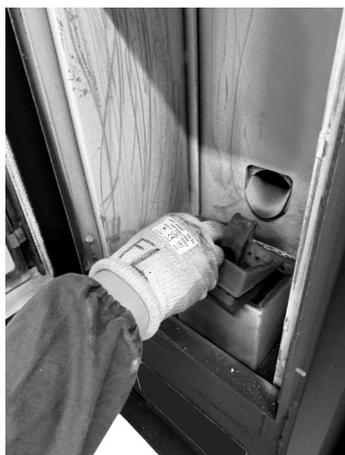
*Fig. 33 - Extracción del brasero*
