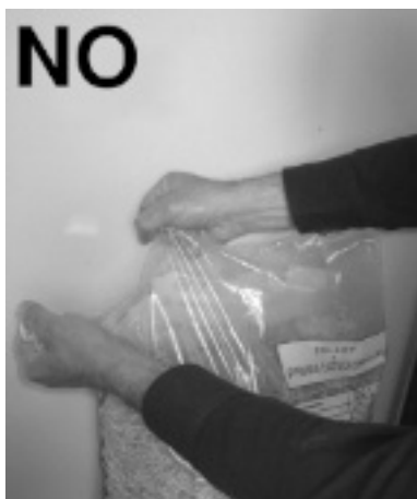
Fig. 24 - Fehlerhafte Öffnung des Pelletsacks
