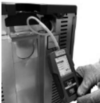
Fig. 46 - Collegamento pressostato digitale
