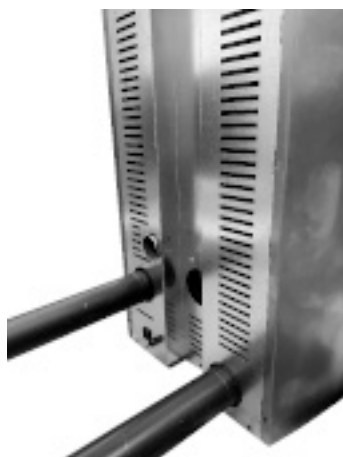
Fig. 31 - Uscita aria calda posteriore
