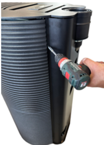
Fig. 17 - De schroeven verwijderen
