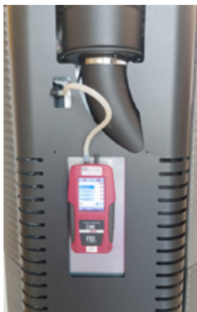
Fig. 35 - Aansluiting digitale drukregelaar
