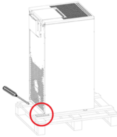
Fig. 1 - Verwijdering van de beugels
