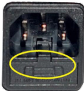
Fig. 59 - Deurtje met te verwijderen zekeringen
