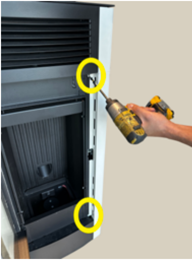
Fig. 26 - De schroeven verwijderen
