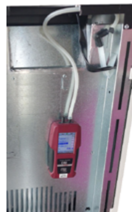
Fig. 36 - Aansluiting digitale drukregelaar
