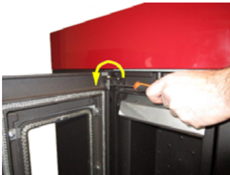
Fig. 15 - Verwijdering van de schroeven
