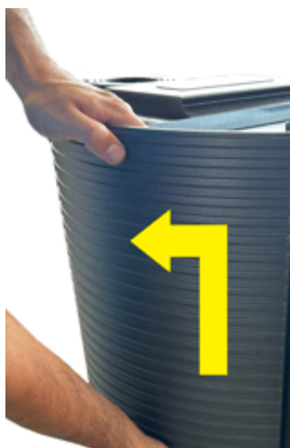
Fig. 24 - Verwijder de bovenste plaat
