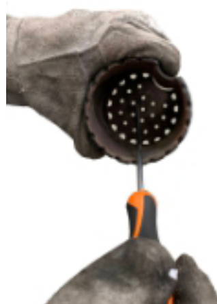
Fig. 38 - het schoonmaken van de vuurpot
