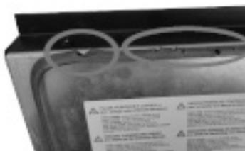
Fig. 25 - Junta deteriorada
