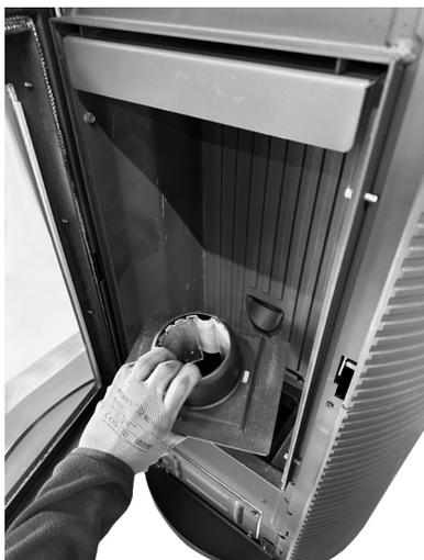
**Fig. 36 - Extracción del brasero**
